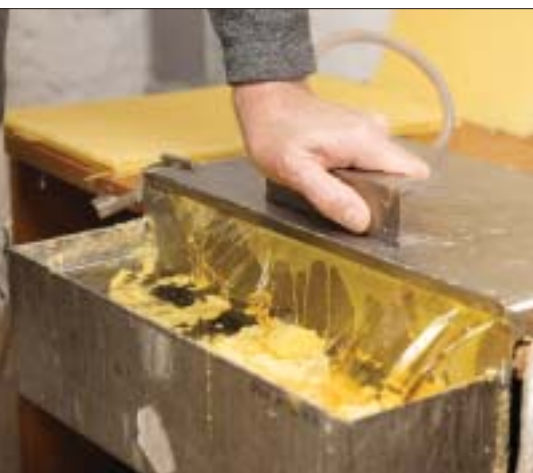
Zuklappen – überschüssiges Wachs läuft in die Wasserwanne.
